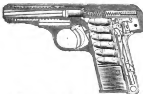
2. Mechanismus der Browningpistole Nr. 1912, abgefeuert, Magazin geladen.
