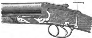
2a. Selbstspannersystem von Anson & Deeley, geschlossen und gesichert. (A Spannhebel, B Hahn, C Stange, D Schlagfeder.)
