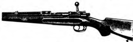
Mauser-Bohrbüchse R. 98 (Schloß halb geöffnet).
