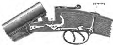
2b. Selbstspannersystem von Anson & Deeley, geöffnet und gespannt, Abzüge gesichert.
